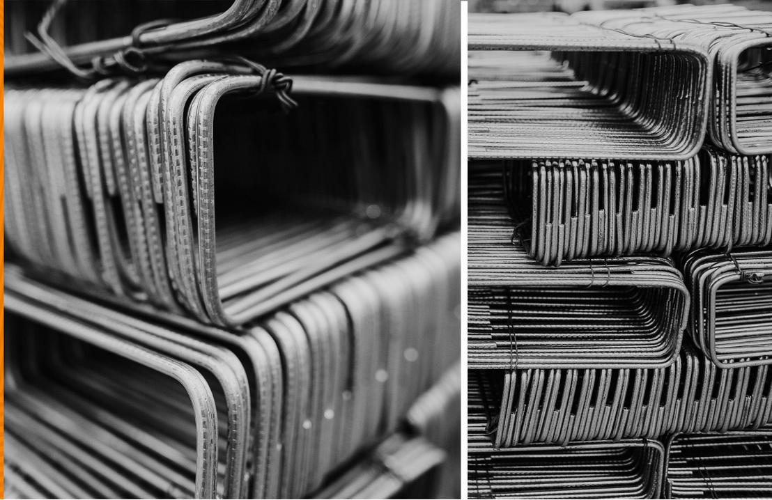
Los estribos son barras de acero dobladas en diferentes formas, que se colocan perpendicularmente a la armadura longitudinal. Sirven para posicionar varillas en el armado de castillos y vigas.
