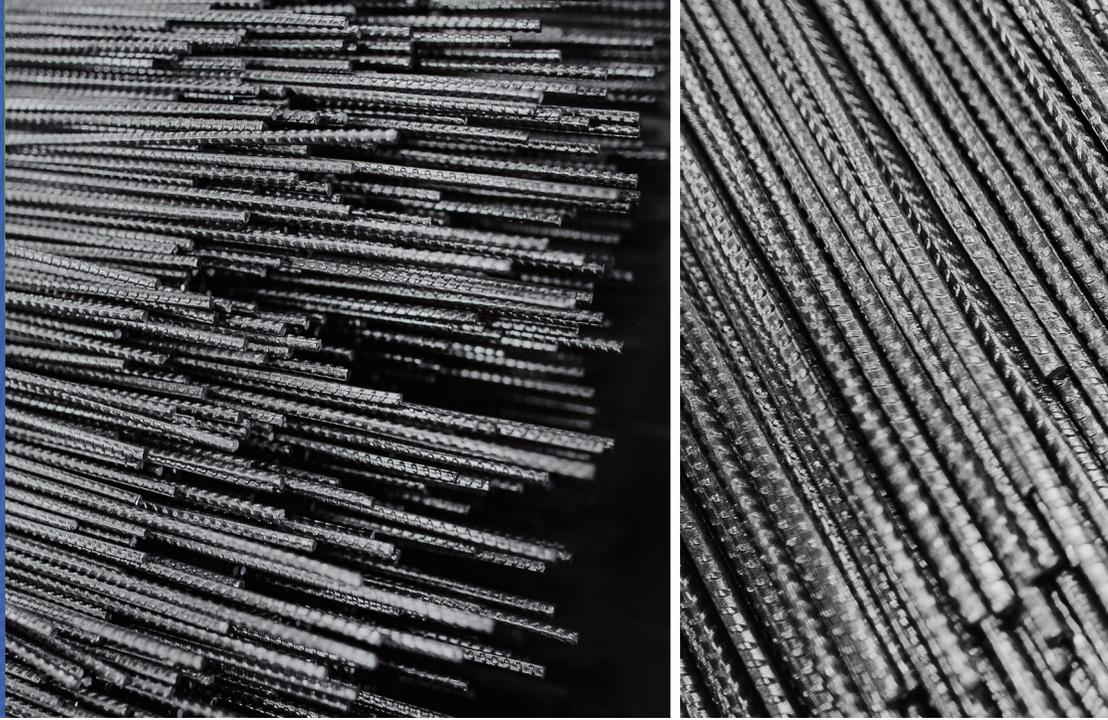
La varilla MS-60 es sumamente resistente a la tensión, por su proceso de fabricación de laminado en frío.
