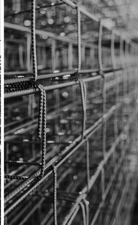
El castillo armacero es una armadura compuesta de alambres longitudinales y transversales unidos por soldadura mediante resistencia. Suele usarse como acero de refuerzo en traveses y columnas.
